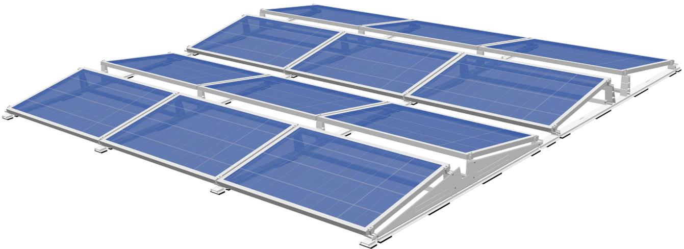
Der Aufbau des Systems mit den Seitenblechen bewirkt eine Verbesserung des  $c_p$ -Wertes, der einen positiven Einfluss auf den benötigten Lageballast hat, sowie zu einer geringeren zusätzlichen Auflast führen kann.
