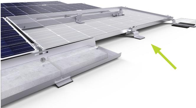
Montage untere Alpinstütze: mit Endhalter in der Mitte der langen Modulseite befestigen.
