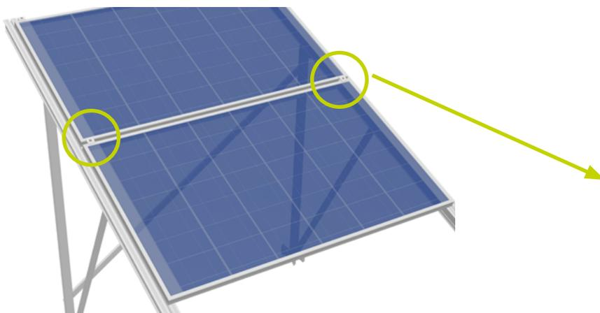
**Modul unterschieben und Modulhalter festziehen**
