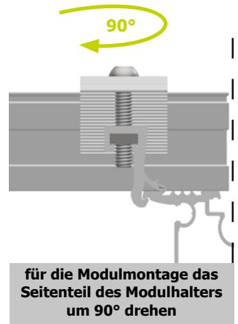
**für die Modulmontage das Seitenteil des Modulhalters um 90° drehen**
