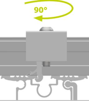
**für die Modulmontage das Seitenteil des Endhalters um 90° drehen**
