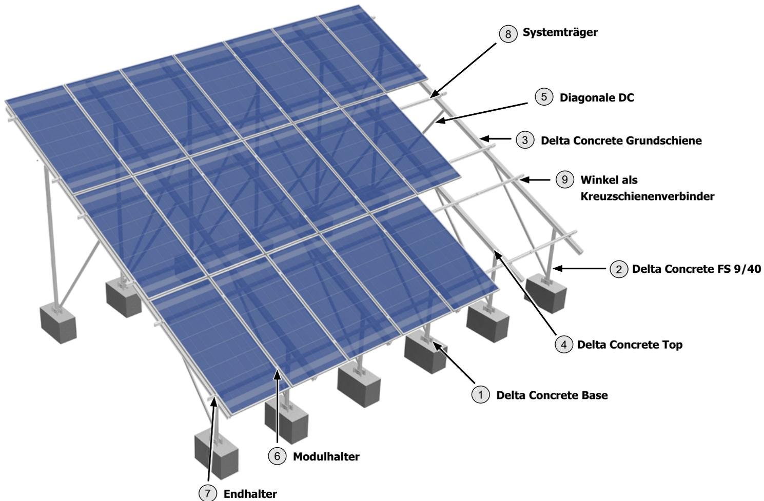
Die Montage der unteren vertikalen Schienenlage erfolgt wie in 2.3.1 „Montage einlagig“ dargestellt.
